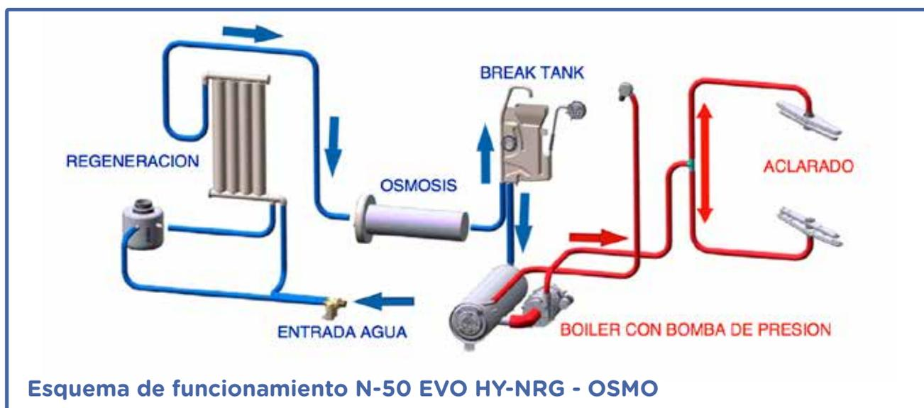
**El tratamiento del agua está compuesto por tres sistemas que, al interactuar entre sí, sitúan el agua en un estado ideal para el lavado.**
